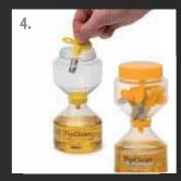
Zuletzt: Düsen entnehmen und gelösten Schmutz mit einer Bürste entfernen oder die Düsen im Behälter lagern.
